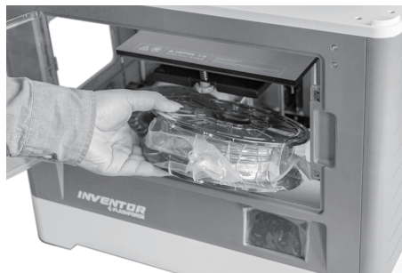
13. 先取出打印耗材，然后取出下方的泡沫。
