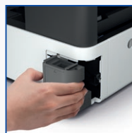
Tanque de manutenção
